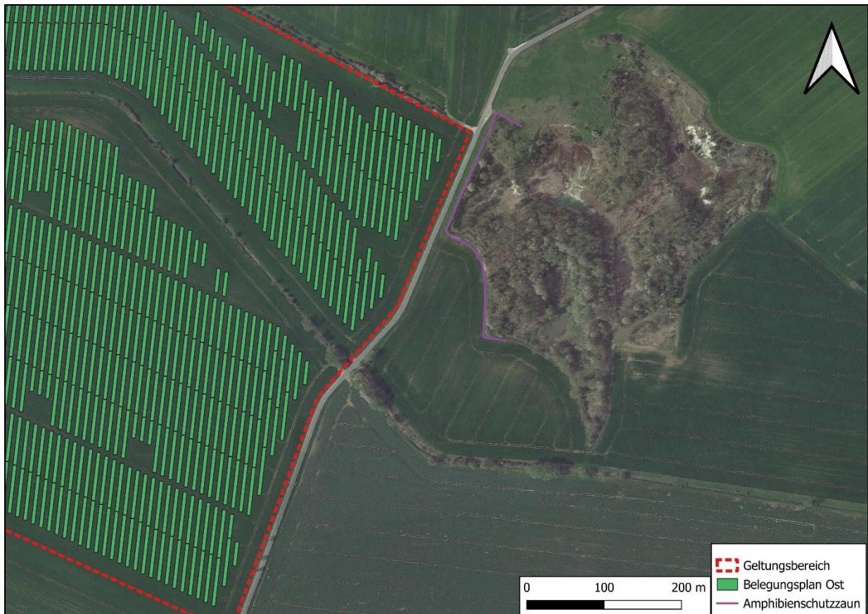
Abbildung 3: Amphibienschutzzaun, der bei einer Bauzeit innerhalb der Wanderungszeit von Amphibien vorgeschlagen wird.
